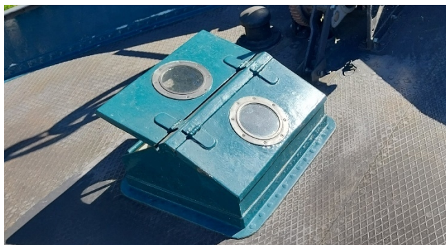
De koekoek is in zijn geheel uitgevoerd in klinkwerk
