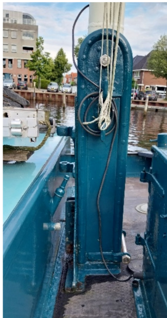
De stuurboord kant van de mastkoker
