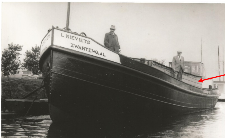
De den is verhoogd met houten opzetstukken ook wel potkast genaamd.
