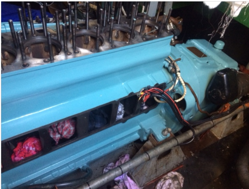
De cilinderkoppen zijn gedemonteerd, de cilindervoeringen getrokken en het uitlaatspruitstuk is er afgenomen. Foto Fredi Leijenaar
