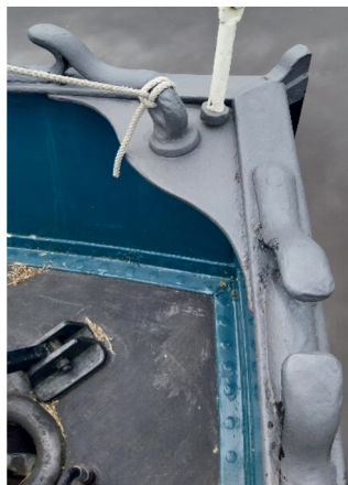
De wandputtings waar stagspanners of spanschroeven op gezet konden worden.
