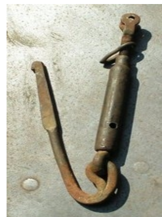
Foto: P. Klein. Een spanschroef met pelikaan haak.
