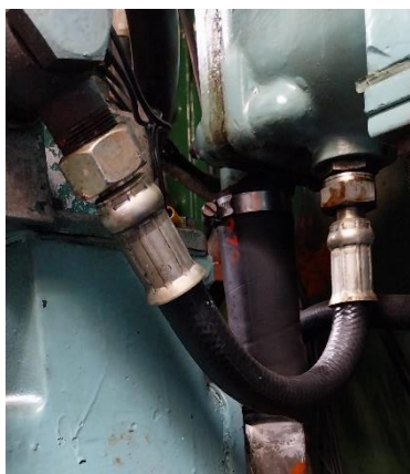
De oude slang maakt een te krappe bocht waardoor de mantel scheurt
